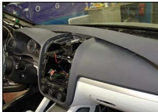
Une fois démonté l'ensemble de la console centrale, Julio s'attaque à toute la partie collée contre le pare-brise. Celle-ci va en effet servir de support aux deux ensembles médium-tweeter.
