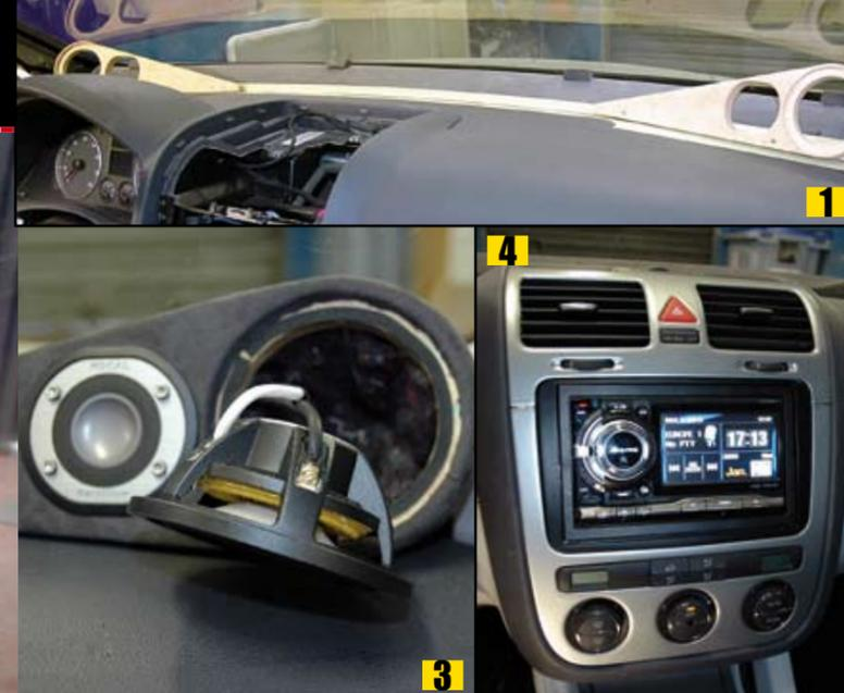
■ -1- Pour ce faire, une pièce nouvelle est découpée dans un panneau de particules, avec les deux baffles des haut-parleurs à chaque extrémité. L'ensemble vient s'ajouter à la pièce d'origine démontée.
